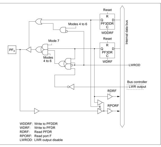
Figure 5.41 (d) Port F Block Diagram (Pin PF<sub>3</sub>)
