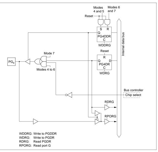
Figure 5.42 (d) Port G Block Diagram (Pin PG<sub>4</sub>)
