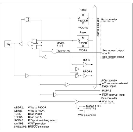
Figure 5.31 (d) Port 5 Block Diagram (Pin P5<sub>3</sub>)
