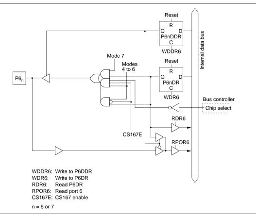
Figure 5.32 (d) Port 6 Block Diagram (Pins P6<sub>6</sub> and P6<sub>7</sub>)
