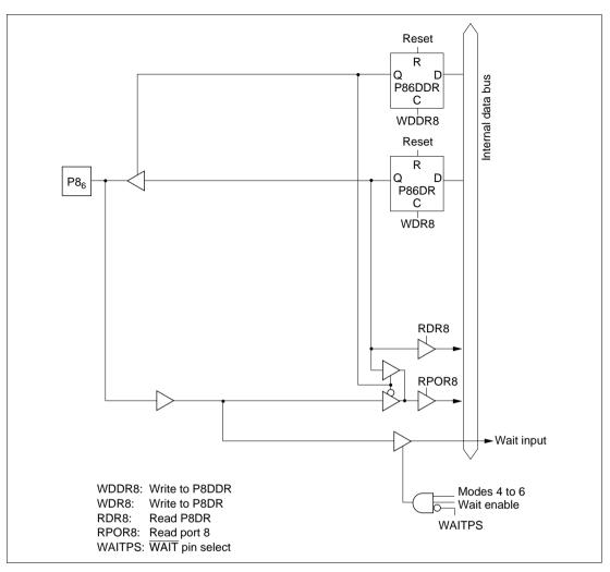
Figure 5.34 (d) Port 8 Block Diagram (Pin P8<sub>6</sub>)
